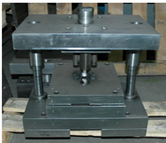
Rys.9. Wykrojnik i wykonana wypraska.
