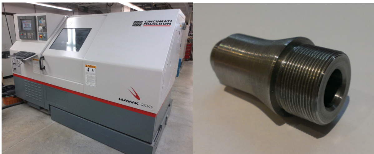
Rys. 12. Obrabiarka wykorzystana do procesu obróbki widocznej, wykonanej tulei
