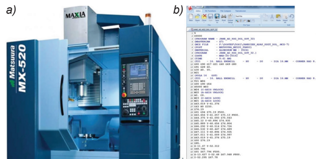
Rys. 6. Obrabiarka użyta do obróbki płyty kształtowej (a), fragment kodu sterującego NC (b)
